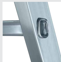
4-fach gebördelte Sprossen- / Holmverbindung
